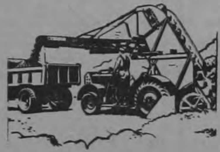
Modelo 543. —Con llantas neumáticas corre en carretera hasta 15 m.p.h. El transportador es controlado hidráulicamente.
