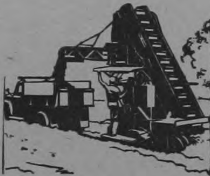
Modelo 82A. —Tiene estabilidad para excavar trabajando en depósitos de grava o en terrenos suaves con barro.
